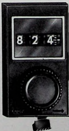
Bild 1: Digital-Einsteller für genaue Einstellung von Präzisionspotentiometern (TWK-Pressbild)
