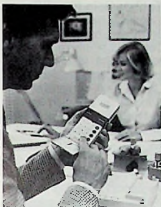
Bild 1: Bis 200 m kann man sich mit dem Mobilteil des Telefons vom Basisgerät entfernen (Siemens-Pressbild)
