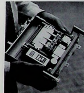
Bild 1: Beschleunigungs-Registriergerät zum Überprüfen von Versandwegen (Akai-Pressbild)
